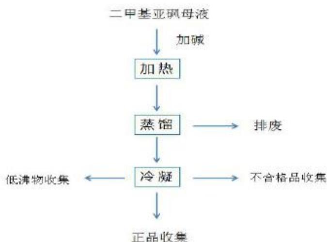
图 2-7 二甲基亚砷回收工艺流程图
